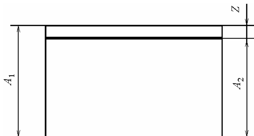
Рисунок 3.1 – Простейшая операционная размерная цепь
