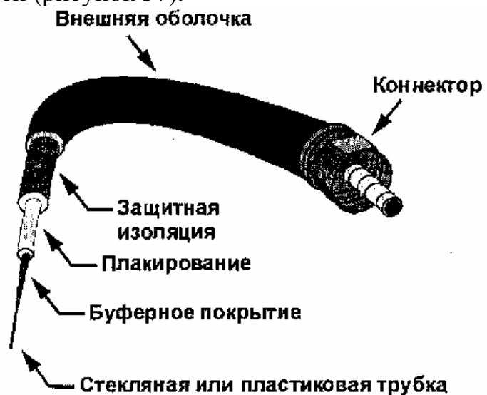
Рисунок 37 - Оптоволоконный кабель с типичным разъёмом FDDI
