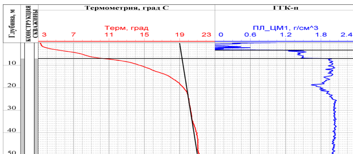
Рисунок 10 - Отбивка уровня цементного камня (ЦК) за колонной по данным термометрии, \gamma\gamma -цементомера.
