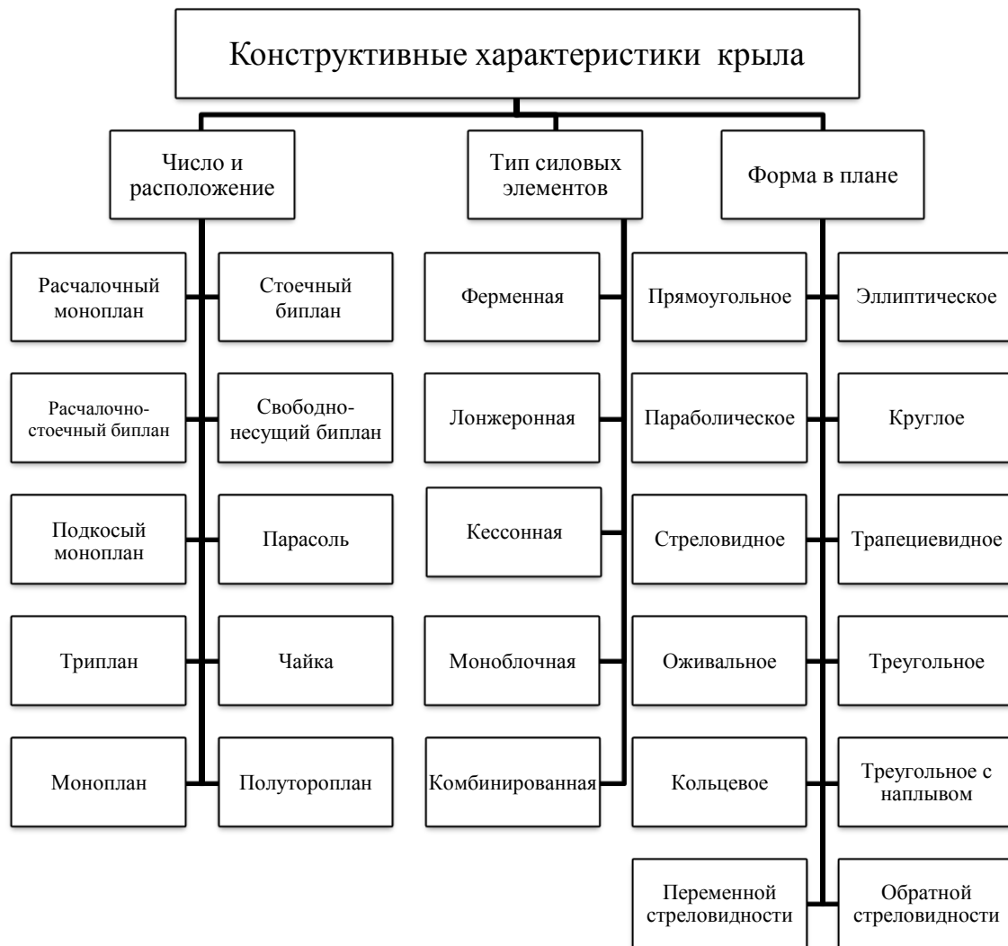
Рисунок 1.7 — Конструктивные характеристики крыла ВС
