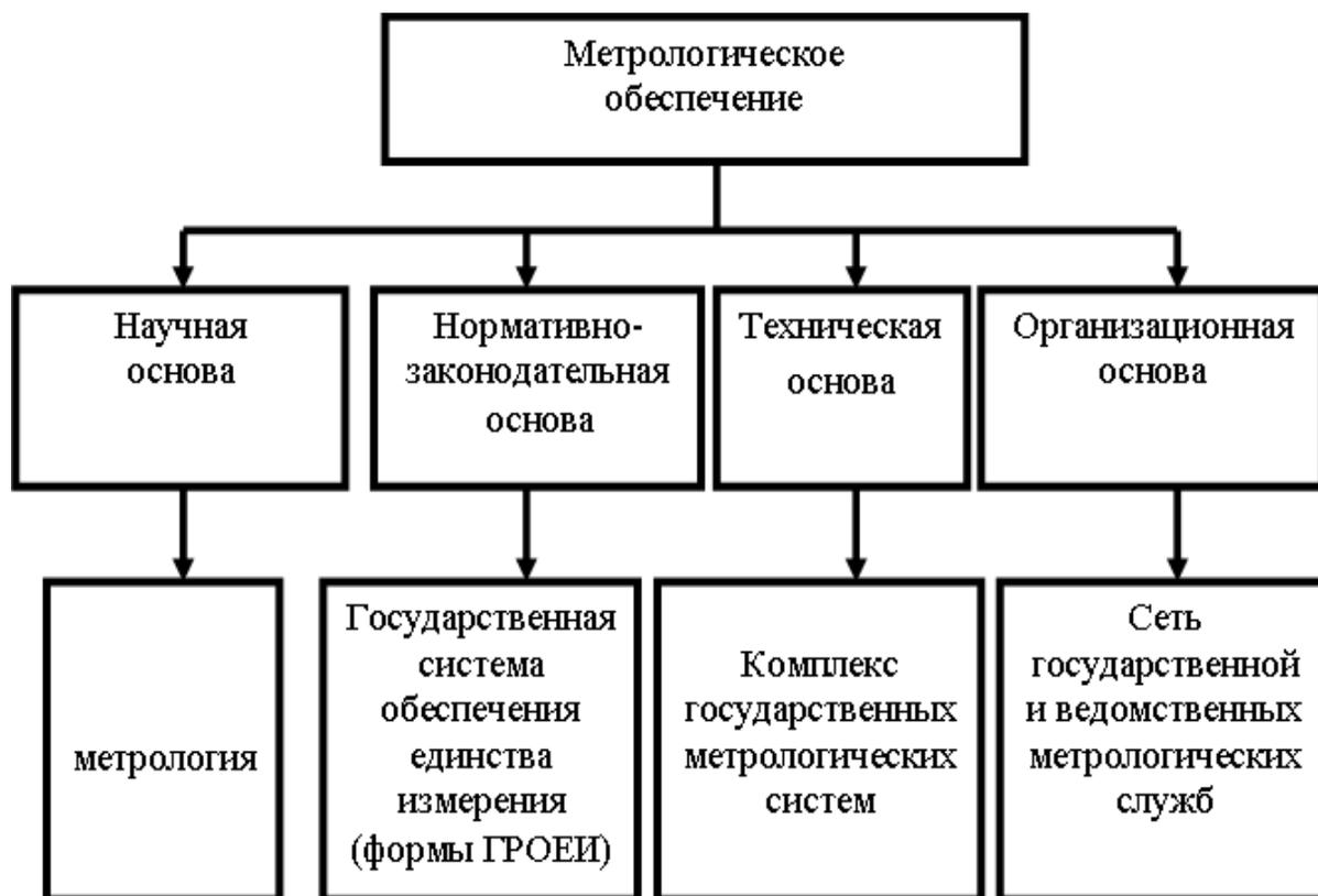
Рисунок 3.13 – Структура метрологического обеспечения
