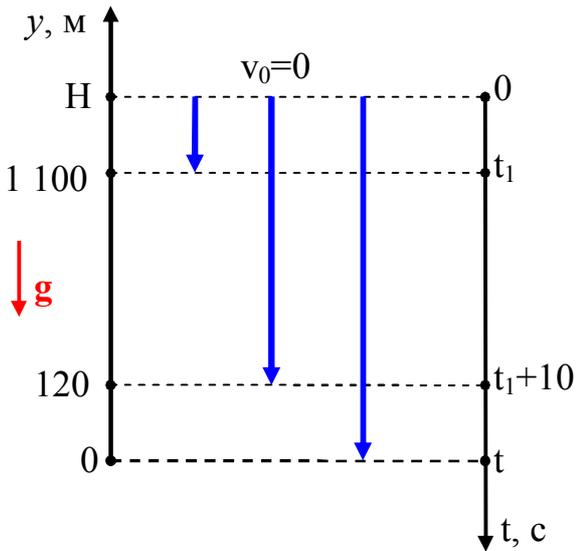
движения возьмем вертикальную ось  $Oy$  с началом на поверхности земли. Раз тело падает свободно, то начальная скорость  $v_0 = 0$ . Обозначим  $H$  – искомая высота,  $t$  – время падения (см. рисунок).
