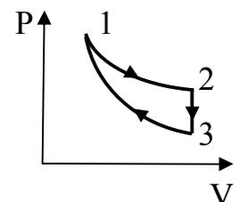
совершенную  $\nu$  молями одноатомного идеального газа в изотермическом процессе.
