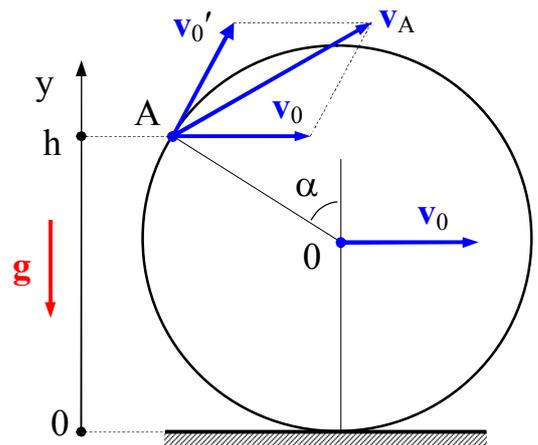
Тогда капля воды, срываясь с обода колеса в точке  $A$ , поднимется от точки  $A$  на высоту  $h_A$ , определяемую соотношением:
