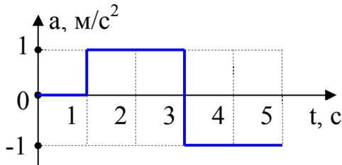
$$a_2 = \frac{v(5) - v(3)}{5 - 3} = \frac{2 \text{ м/с} - 4 \text{ м/с}}{2 \text{ с}} = -1 \text{ м/с}^2.$$
