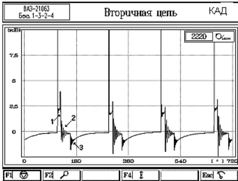
Рисунок 4.48 – Осциллограммы напряжения вторичной цепи при обрыве во вторичной обмотке катушки зажигания
