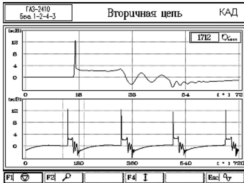
Рисунок 4.54 - Осциллограммы напряжения вторичной цепи бесконтактной системы зажигания
