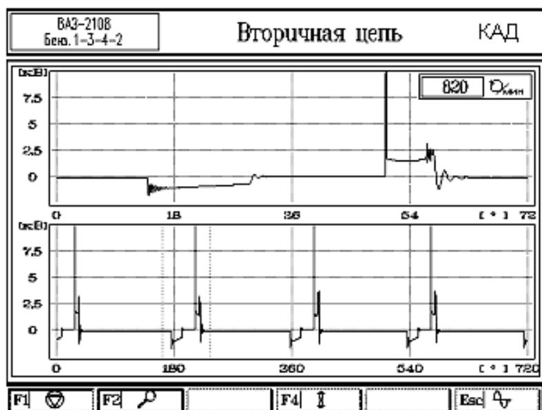
Рисунок 4.56 - Осциллограммы напряжения вторичной цепи бесконтактной системы зажигания с датчиком Холла
