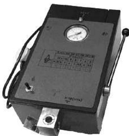
Рисунок 2.13 – Прибор для проверки свечей зажигания Э203-П
