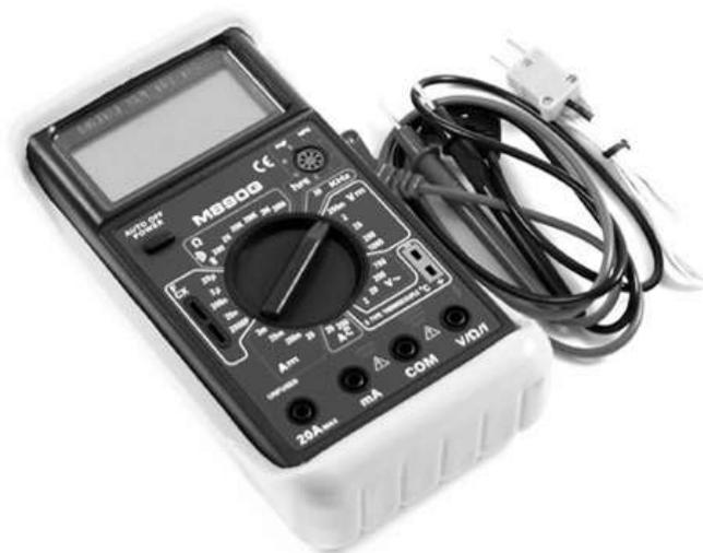
Рисунок 2.14 – Цифровой мультиметр M890G
