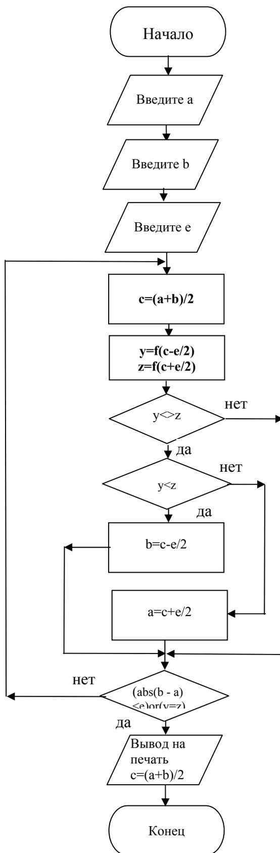
Рисунок 2.5 - Блок-схема нахождения минимума функции одной переменной методом дихотомии(половинного деления)
