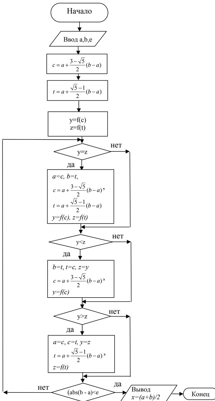
Рисунок 2.9 - Блок-схема нахождения минимума функции одной переменной методом золотого сечения
