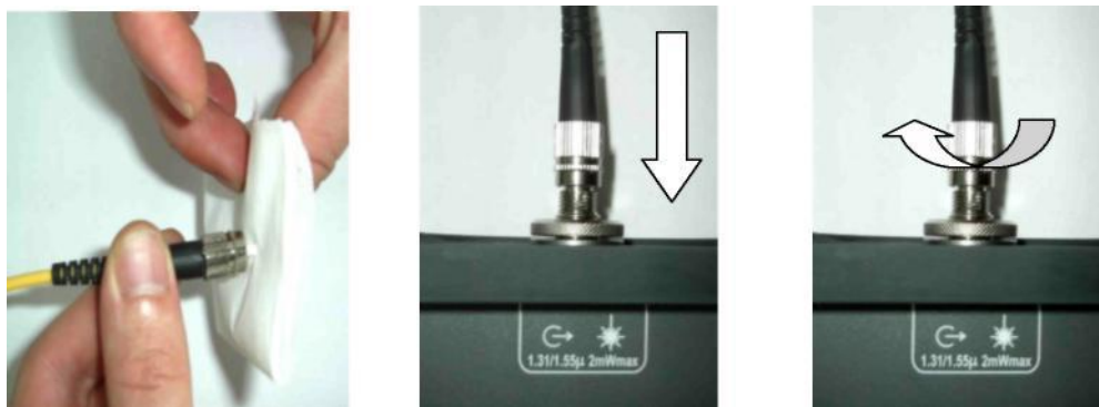
Рисунок 29 - Подключение ОВ к источнику оптического излучения
