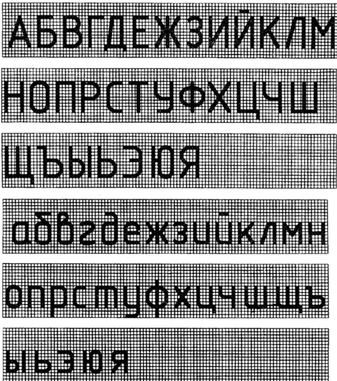
Рисунок 10 – Шрифт тип Б без наклона
