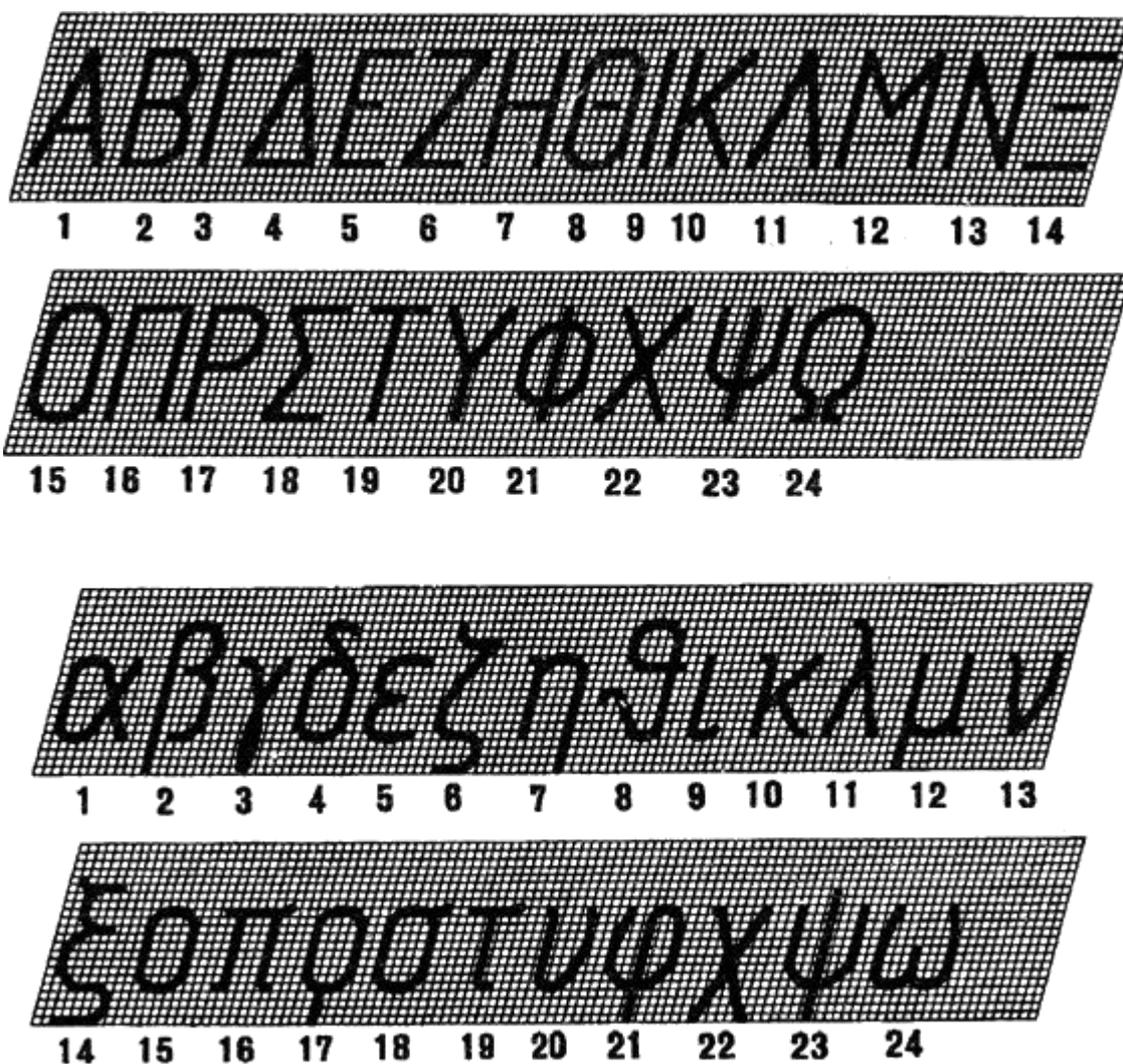
Рисунок 21 – Шрифт типа А с наклоном
