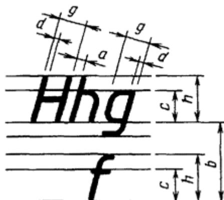
Рисунок 4 – Параметры шрифта с наклоном
