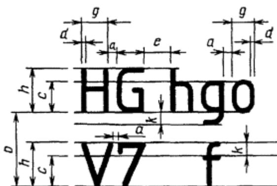
Рисунок 3 – Параметры шрифта без наклона
