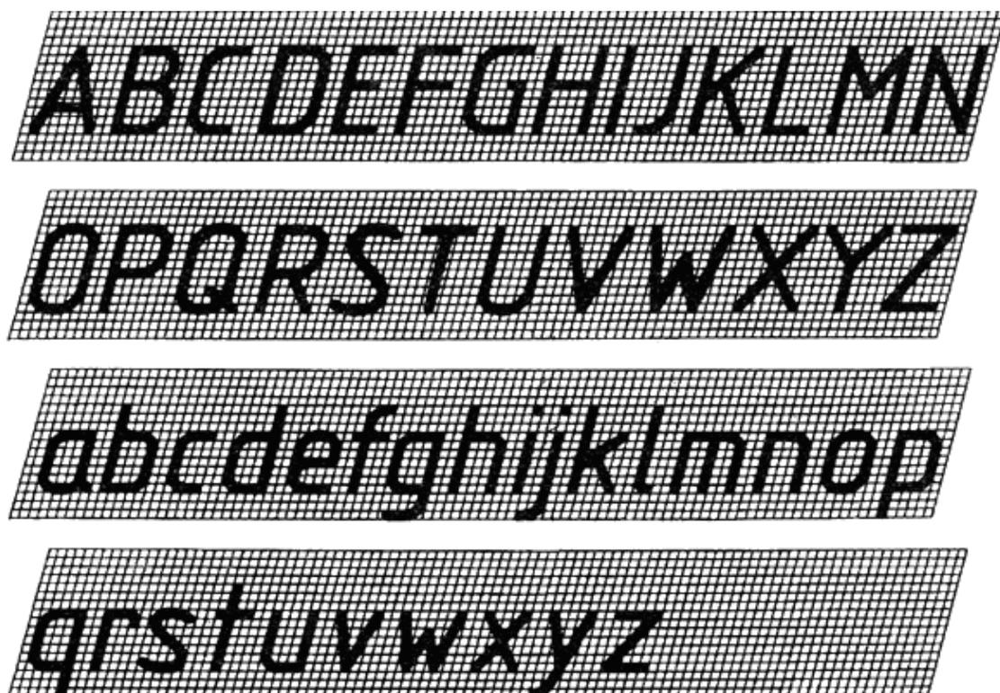
Рисунок 17 – Шрифт типа А с наклоном
