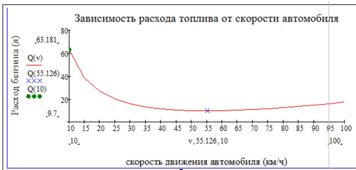
Рисунок 55 – Вид графической зависимости расхода топлива от скорости автомобиля с отметками скоростей с наименьшим и наибольшим расходом
