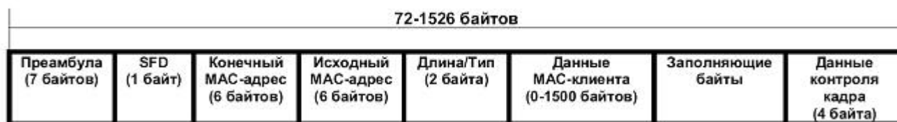
Рисунок 4.9 - Базовая структура кадра Ethernet
