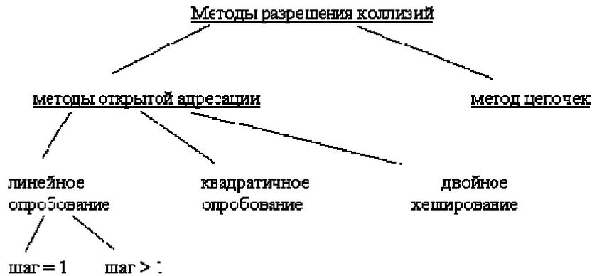
Рисунок 6.2 – Разновидности методов разрешения коллизий
