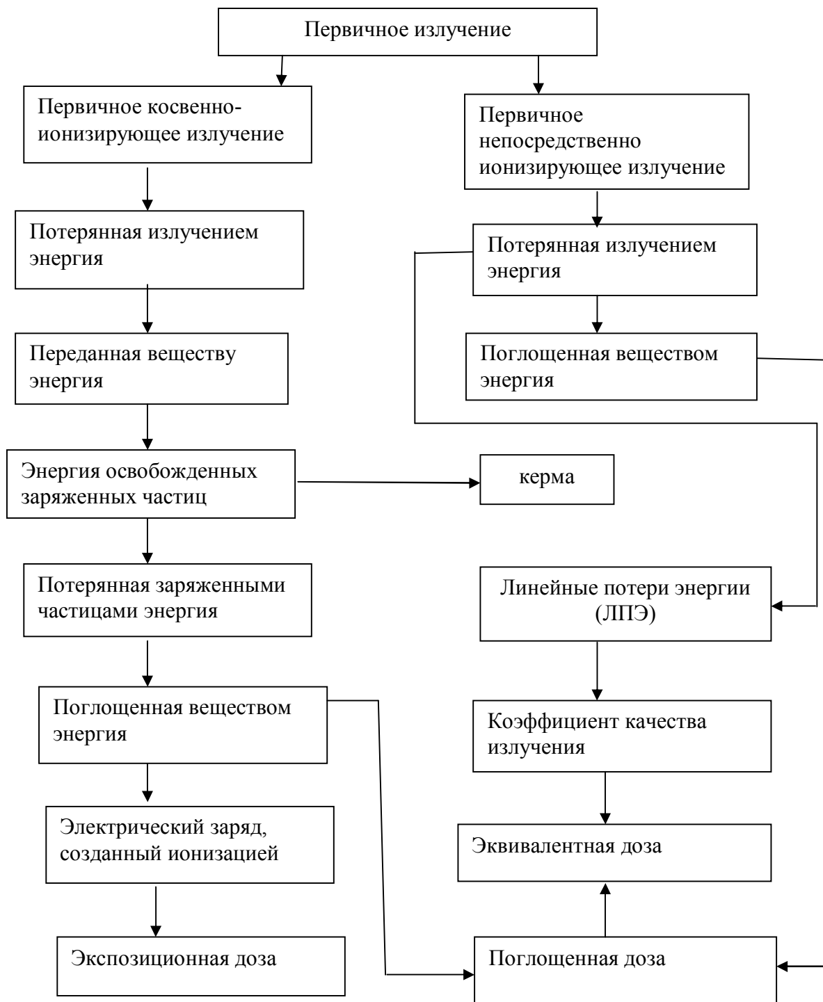
Рисунок 17 - Схема образования доз в поле излучения
