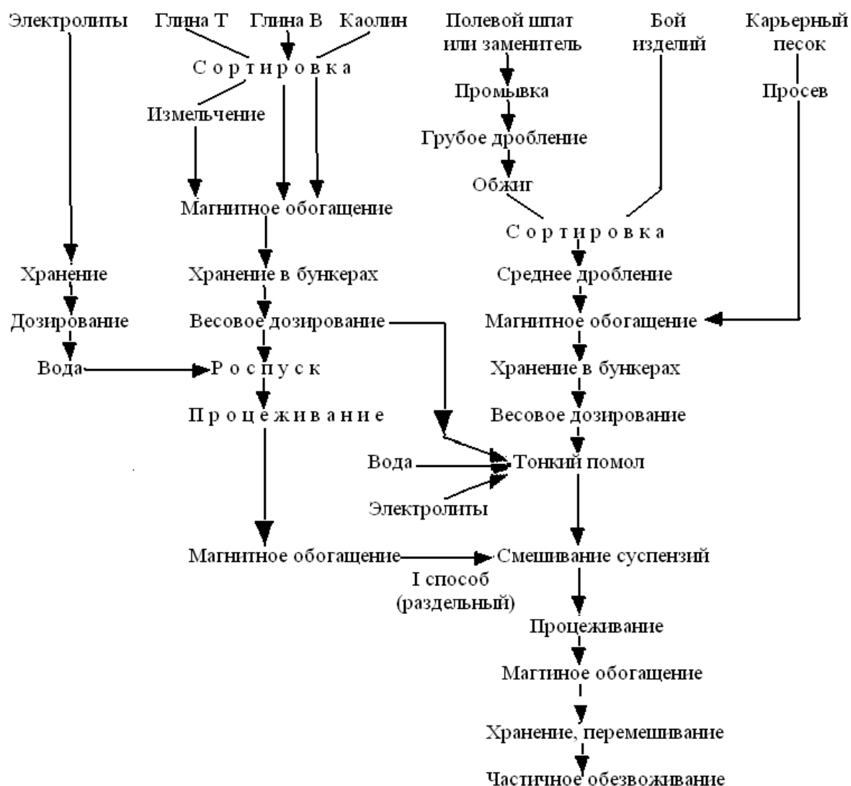
Рисунок 5.8 – Технологическая схема раздельного способа шликерной технологии приготовления массы
