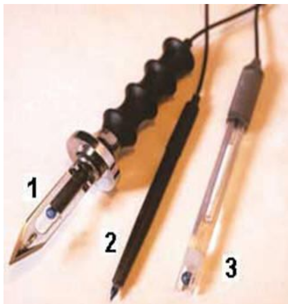
Рисунок 4 - Стеклянный мембранный электрод:
