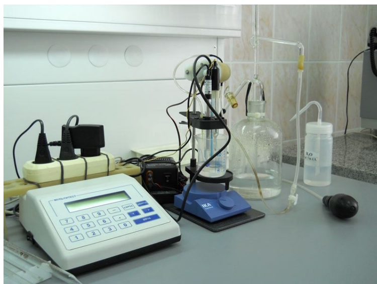
Рисунок 5 - Установка для проведения потенциметрического титрования
