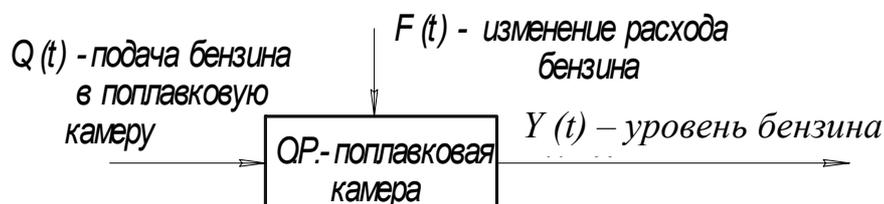
Рисунок 2 - Функциональная схема ОР и сигналы, воздействующие на него
