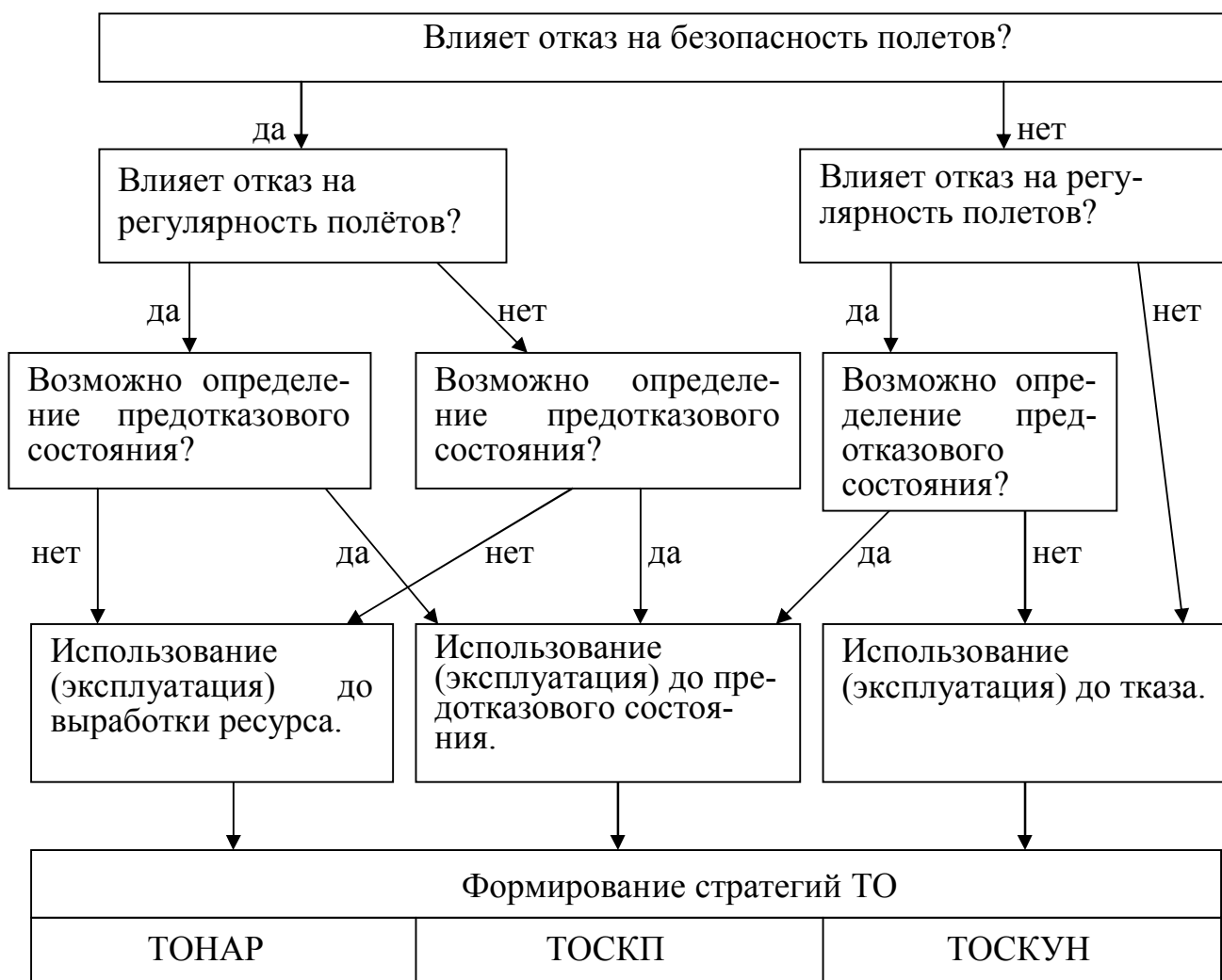
Рисунок 5 - Логическая схема выбора рациональных стратегий использования и технического обслуживания для изделий функциональной системы
