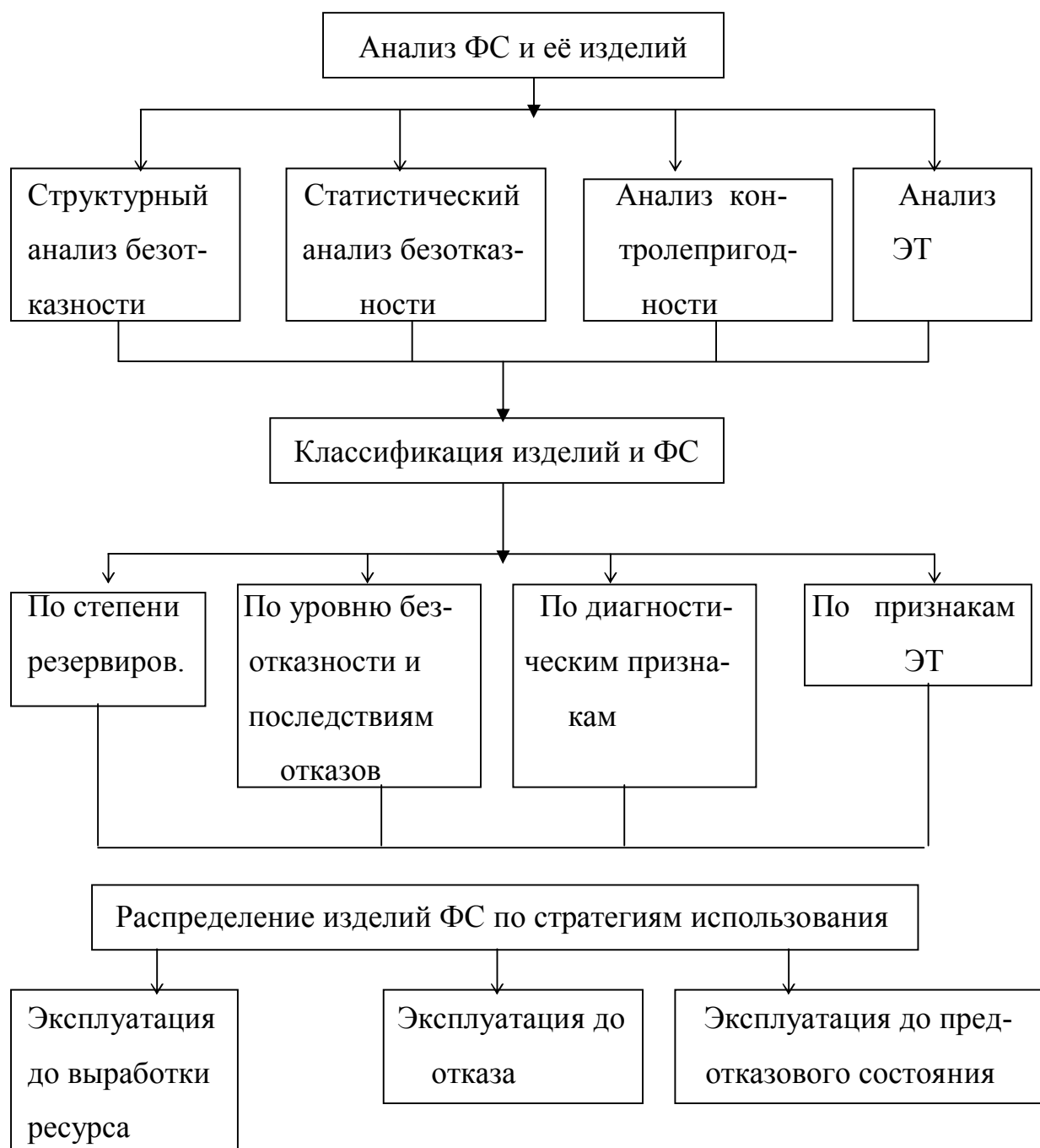
Рисунок 1 – Последовательность действий при выборе стратегий использования изделий функциональной системы
