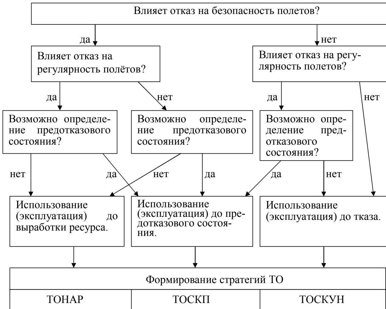
Рисунок 2 - Логическая схема выбора рациональных стратегий использования и технического обслуживания для изделий функциональной системы
