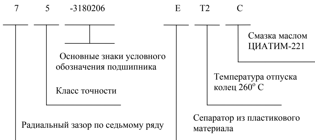
Рисунок И.4 – Пример условного обозначения подшипника с дополнительными знаками.
