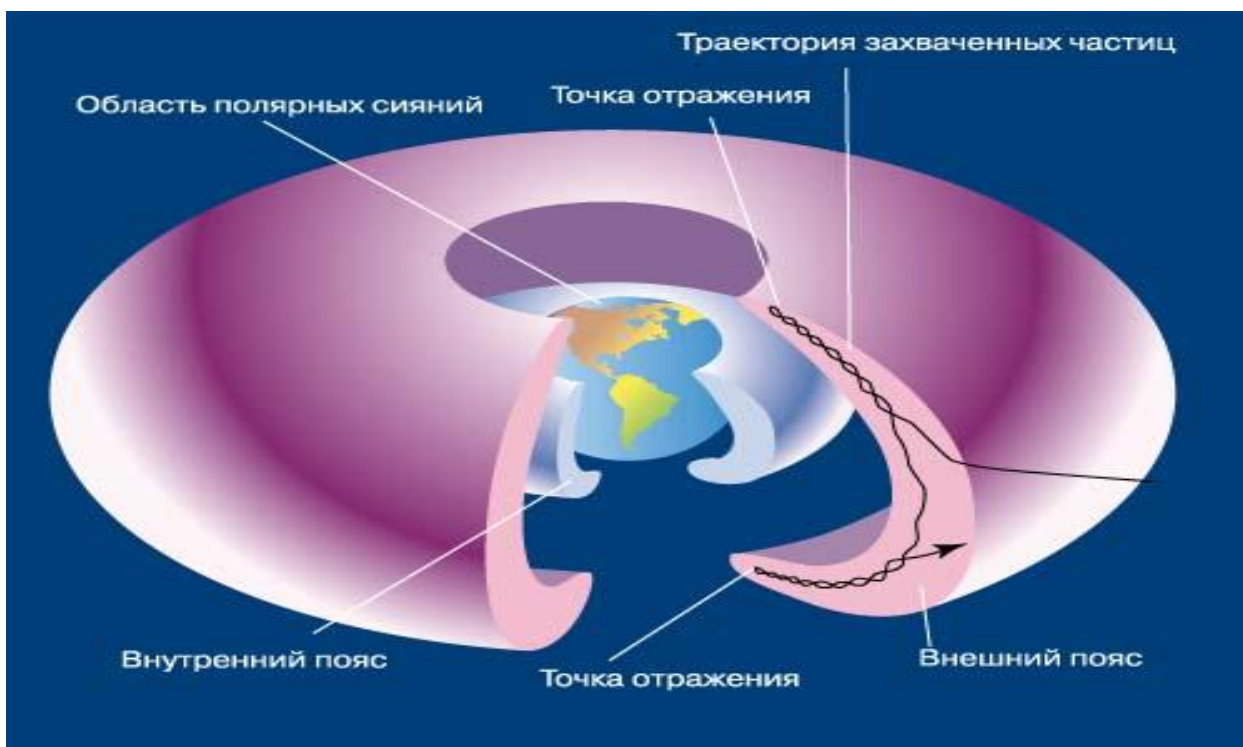
Рисунок 3 – Пояса Ван Аллена. Два концентрических тороидальных радиационных пояса, охватывающих Землю. В них заключены высокоэнергетичные заряженные частицы, излучаемые Солнцем и захватываемые магнитным полем Земли (по материалам Л.А. Арцимовича (НПФ Сапфир))
