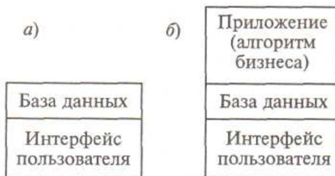
Рисунок 2.4 - Схема классического (а) и современного (б) подхода при построении БД
