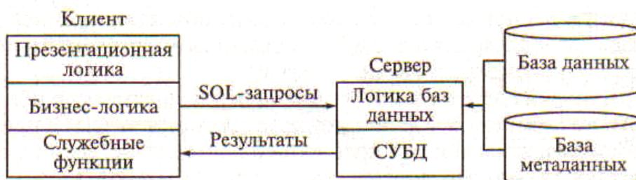
Рисунок 5.4 - Структура модели удаленного доступа к данным
