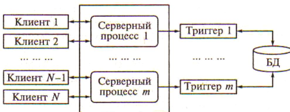
Рисунок 5.10 - Многопоточная мультисерверная архитектура
