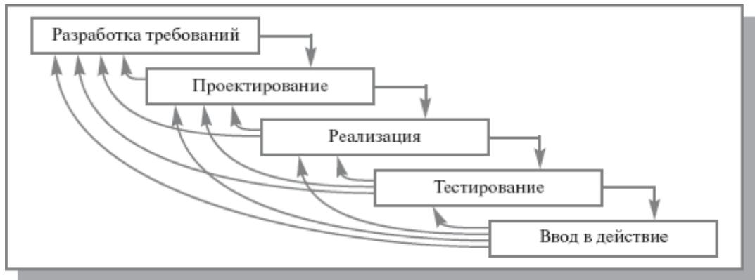
Рисунок 4.5 - Поэтапная модель с промежуточным контролем
