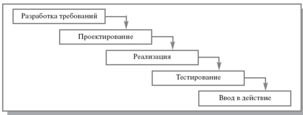
Рисунок 4.4 - Каскадная модель ЖЦ ИС
