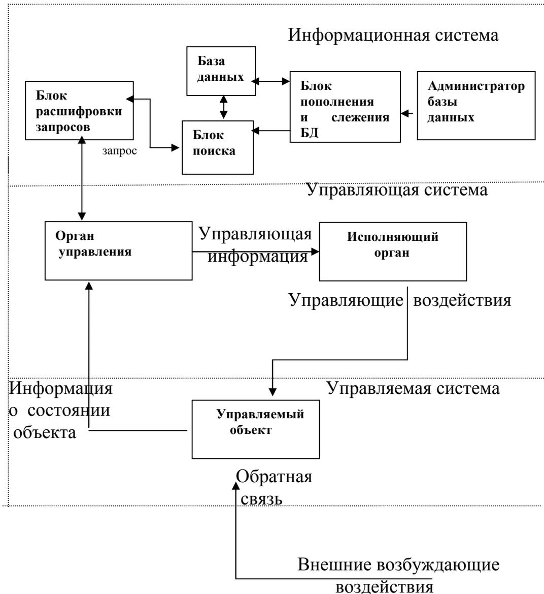
Рисунок 1.7 - Структурная схема АИС
