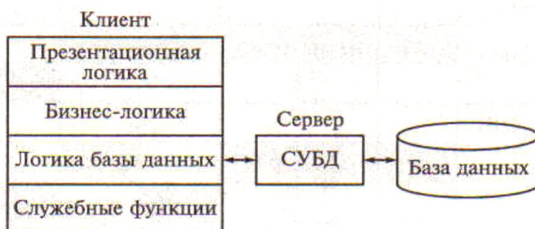
Рисунок 5.2 - Структура типового приложения, работающего с базой данных
