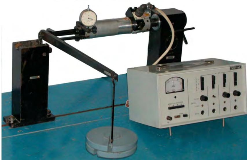
Рисунок 1- Исследование плоского напряженного состояния методом тензометрии
