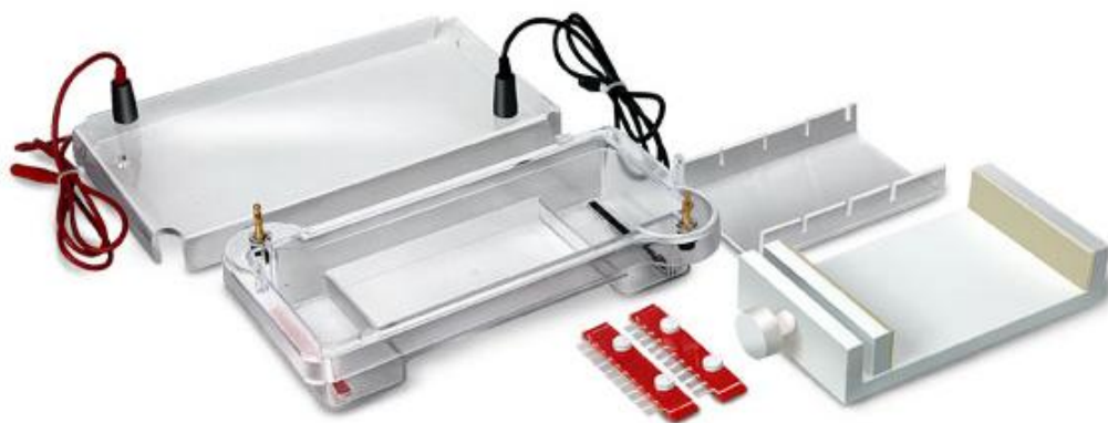
Рисунок 11 – Электрофорезная ванна, подложка и гребенки для горизонтального электрофореза ДНК в агарозном геле
