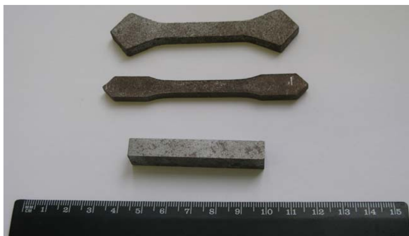
Рисунок 1.18 – Образцы для определения физико-механических свойств порошковых сталей. Лопаточки – для определения прочности и образцы прямоугольного сечения – для определения ударной вязкости
