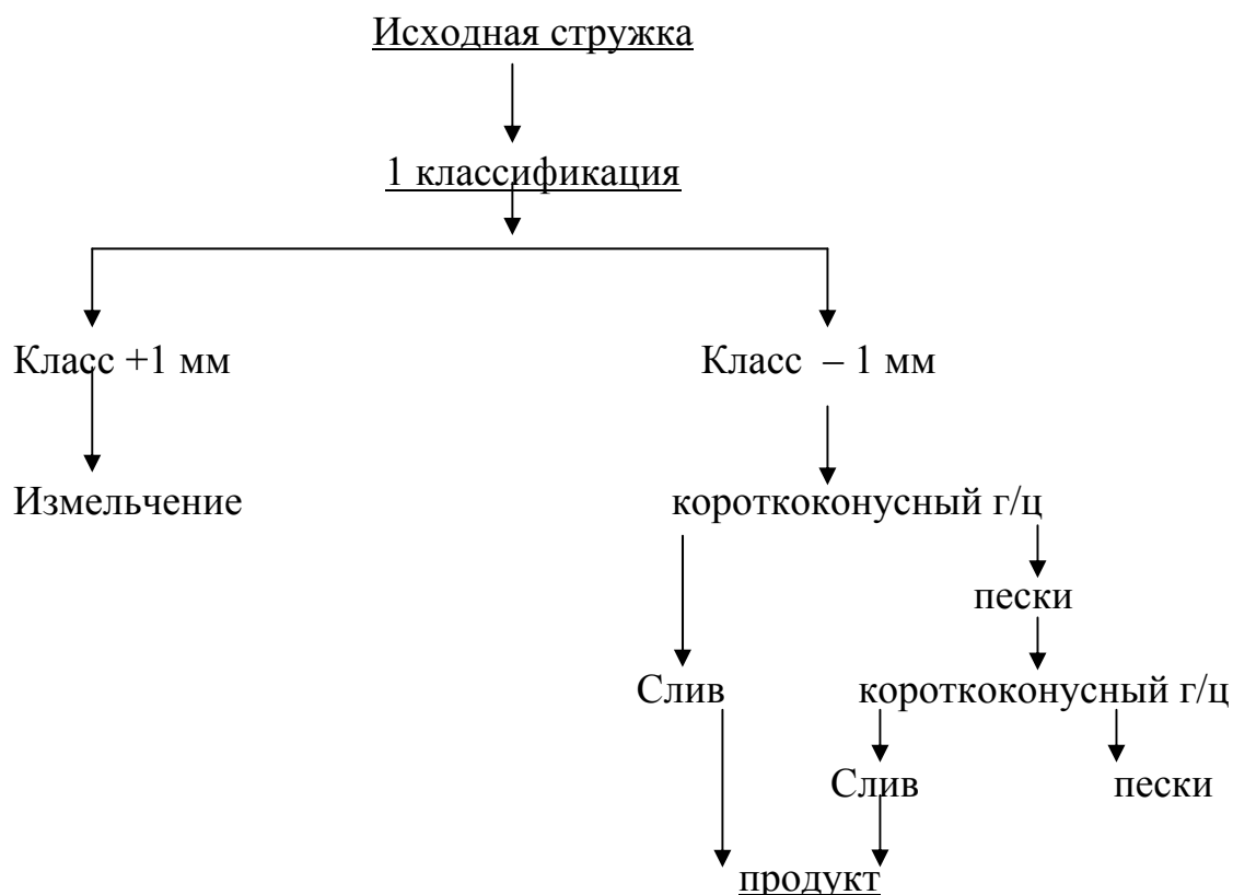
Рисунок 1.7 – Сепарация стружки в короткоконусном гидроциклоне
