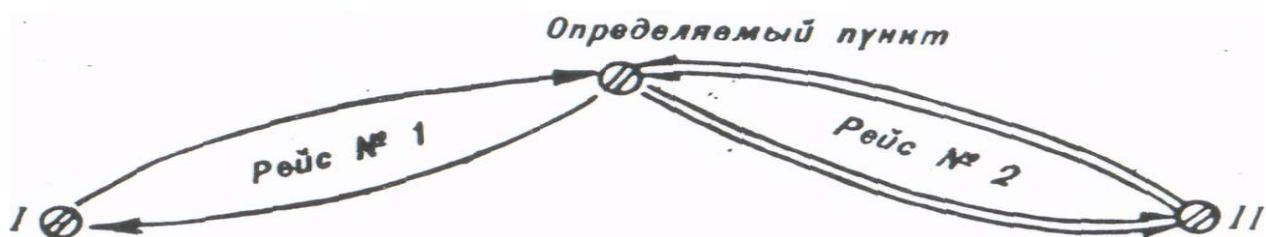
Рисунок 69 - Определение приращений силы тяжести на определяемом пункте относительно пунктов государственной гравиметрической сети РФ
