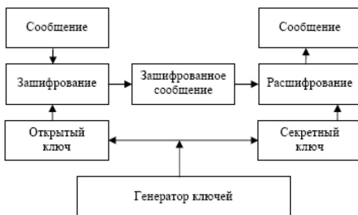
Рисунок 2.4 - Использование асимметричного метода шифрования.
