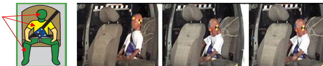
Рисунок 6.7 – Процесс тестирования с применением адаптера ремня безопасности «ФЭСТ» (стрелками указаны результаты тестирования)
