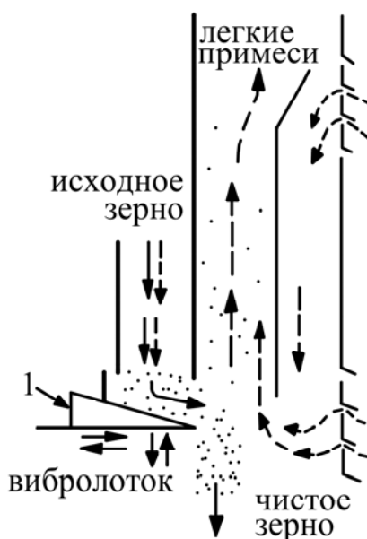
Рисунок 2.6 - Воздушный сепаратор РЗ-БАБ (с разомкнутым циклом)
