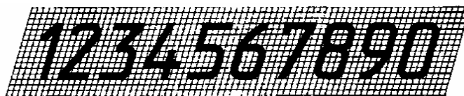
Рисунок 11- Вписывание цифр шрифта типа B с наклоном в сетку
