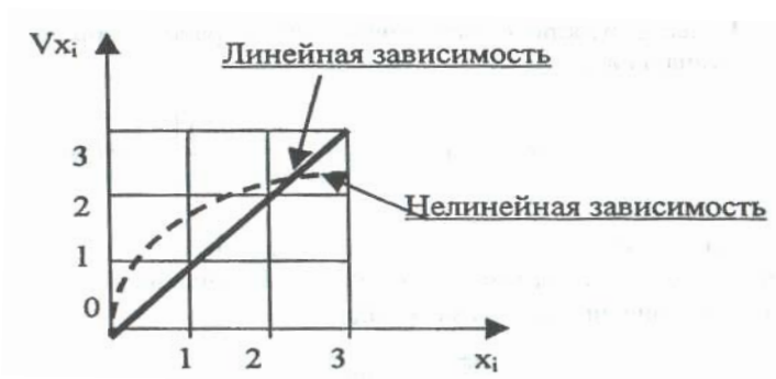
Рисунок 27 - Характер изменения общей производительности бригад в зависимости от их количества
