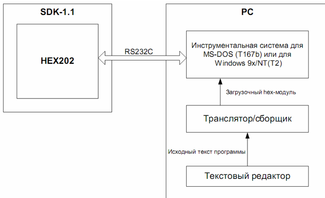
Рисунок 2.1 – Этапы программирования на стенде SDK-1.1
