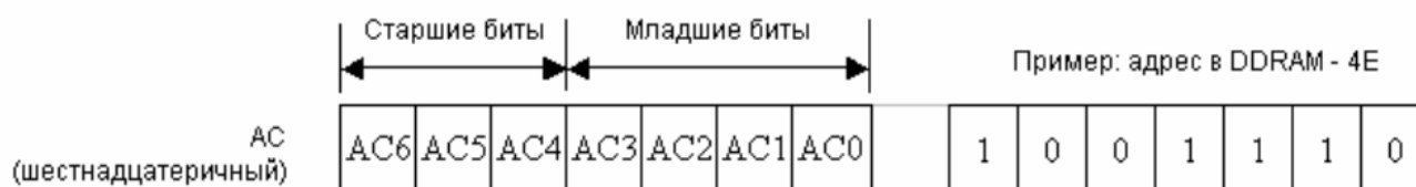
Рисунок 1.5 – Структура памяти данных ЖКИ (DDRAM)
