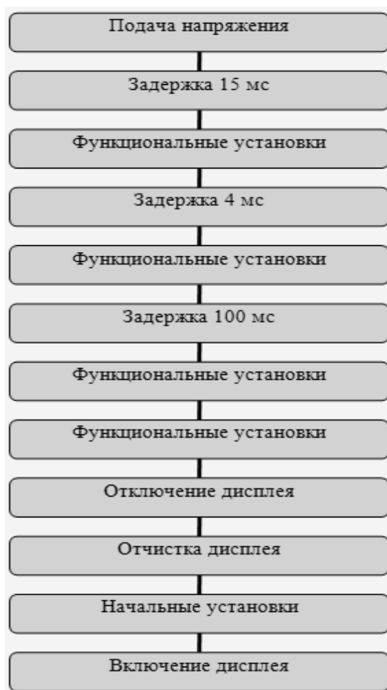
Рисунок 3.1 - Протокол инициализации LCD
