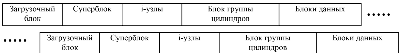
Рисунок 57 – Структура расположения данных в файловой системе UFS
