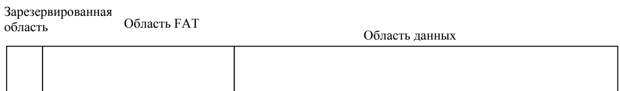
Рисунок 48 – Физическая структура файловой системы FAT
