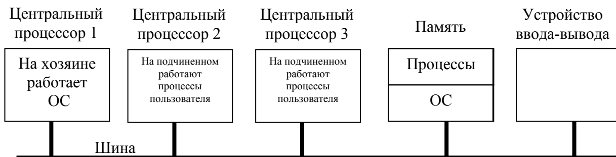
Рисунок 71 – Модель мультипроцессора «хозяин-подчиненный»
