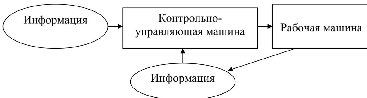
Рисунок 1.7 – Принципиальная схема работы контрольно-управляющей машины
