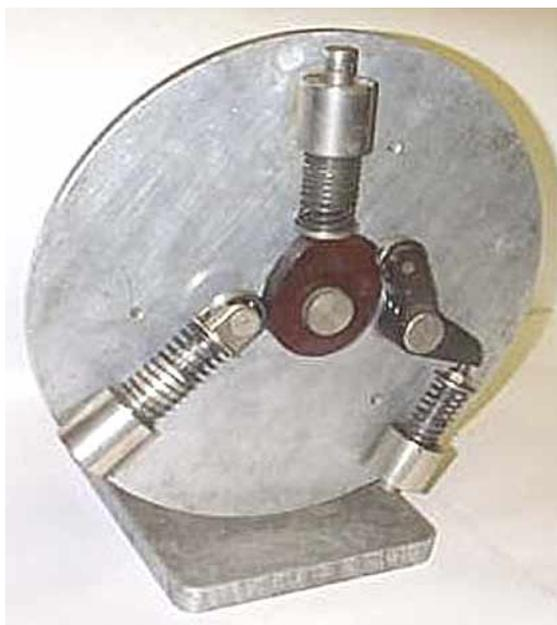
Рисунок 1.15 – Модель кулачкового механизма с плоским дисковым кулачком и с тремя видами толкателей: поступательным с роликом, поступательным без ролика, коромысловым с роликом
