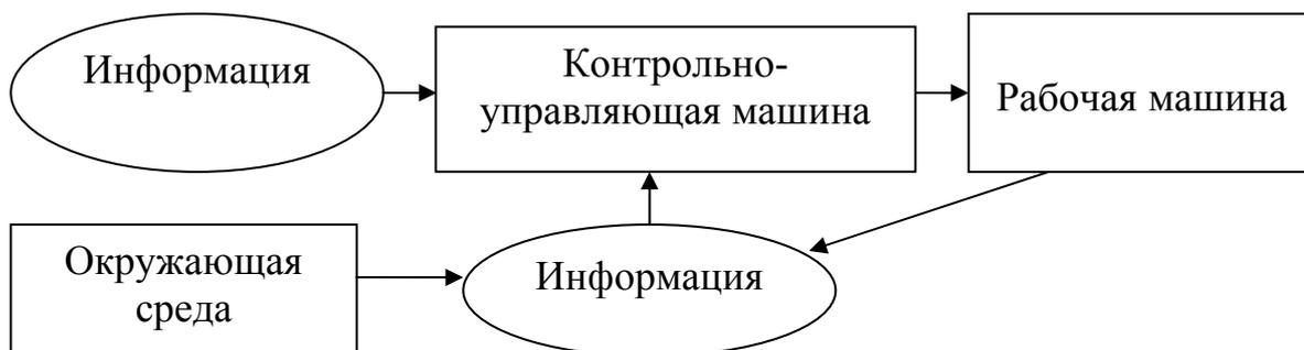
Рисунок 1.8 – Принципиальная схема работы кибернетической машины
