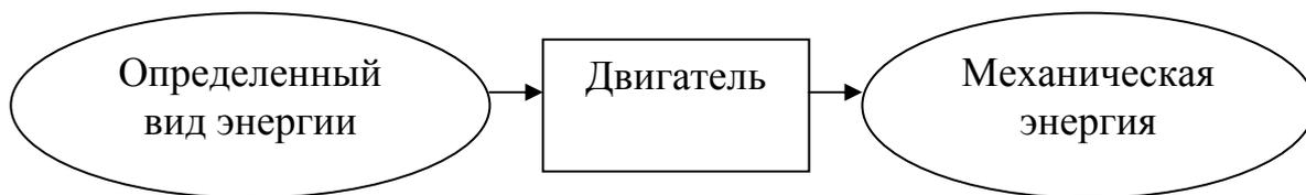
Рисунок 1.2 – Принципиальная схема работы двигателя
