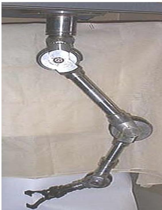
Рисунок 1.16 – Исполнительный механизм копирующего манипулятора
