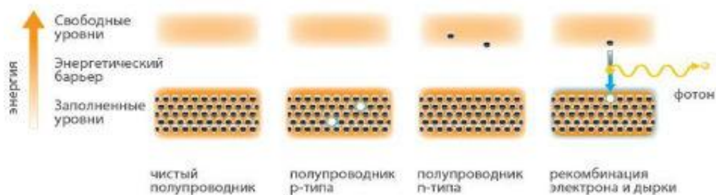
Рисунок 1.17 – Строение и принцип действия светодиода
