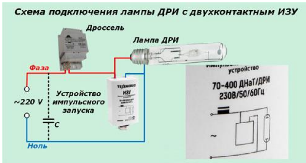
Рисунок 1.13 – Схема включения лампы ДРИ с двухконтактным ИЗУ
