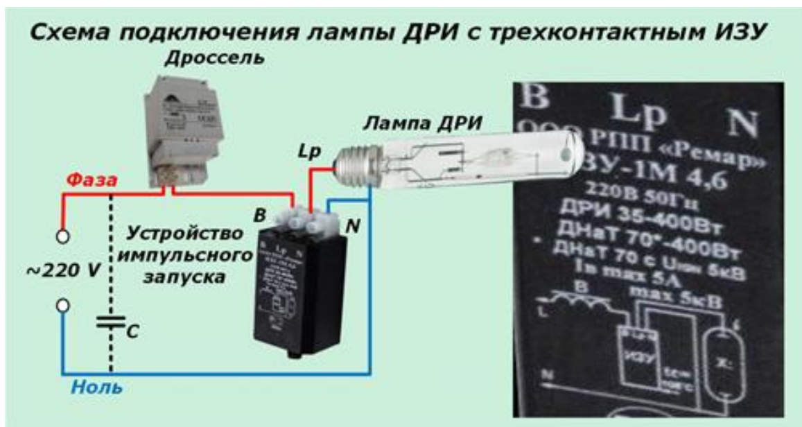
Рисунок 1.14 - Схема включения лампы ДРИ с трехконтактным ИЗУ
