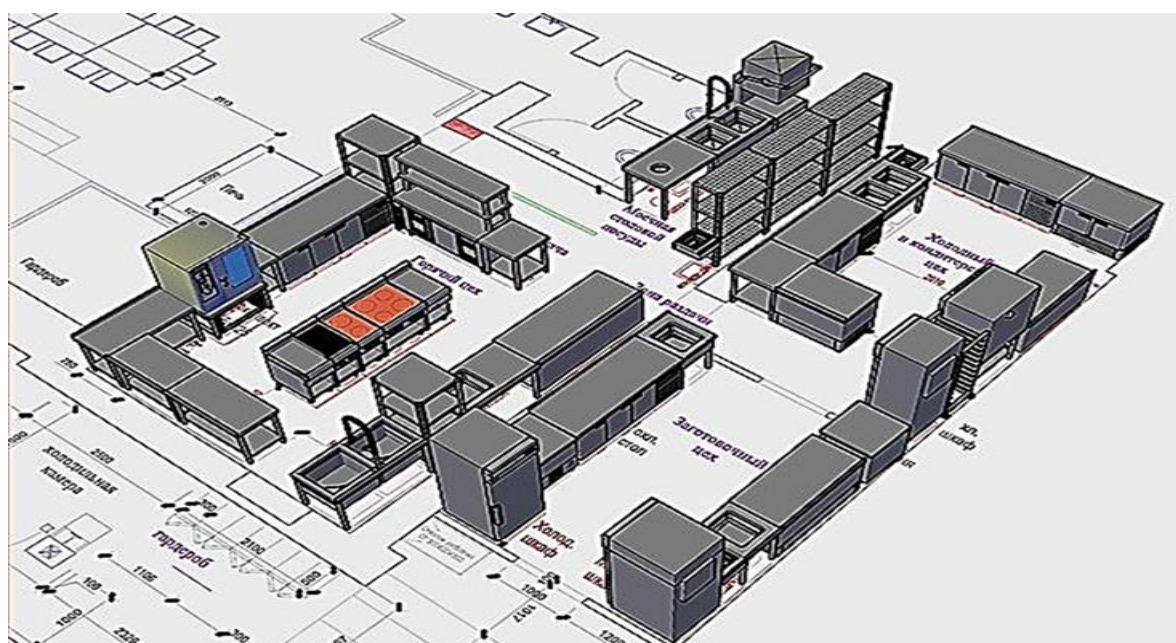
Рисунок 7 - Пример размещения оборудования кухни кафе
