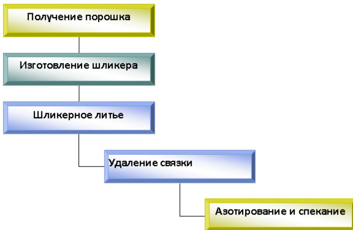
Рисунок 4.4 - Технологическая схема производства реакционно-связанного нитрида кремния
