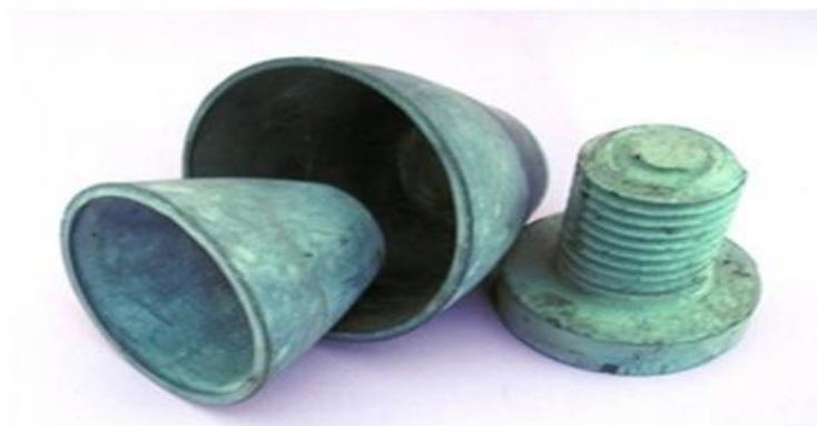
Рисунок 4.8 – Тигли, болт, полученные путем сухого прессования по одноступенчатой технологии
