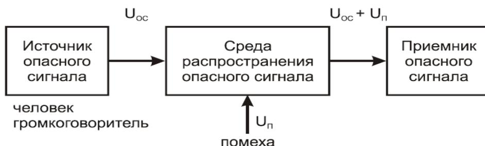
Рисунок 3.1 - Структура акустического канала утечки информации в общем виде
