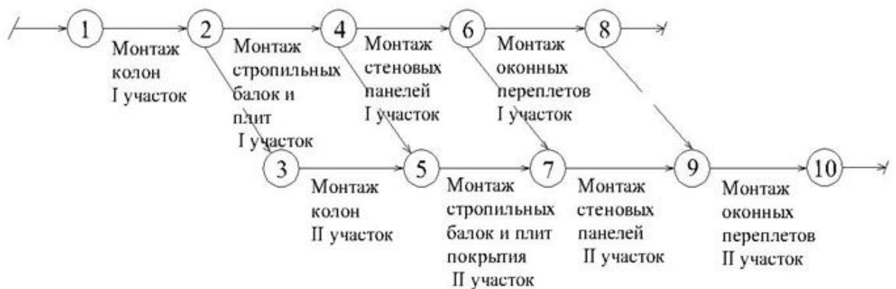
Рисунок 3 - Первичный сетевой график комплекса «Монтаж конструкций каркаса»
