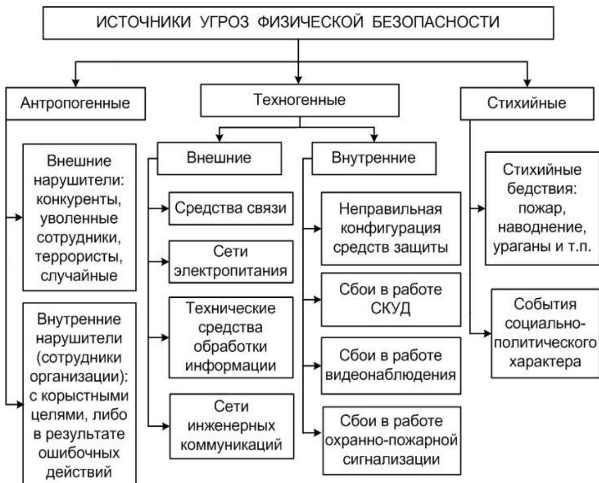
Рисунок 4.6 – Классификация источников угроз физической безопасности
