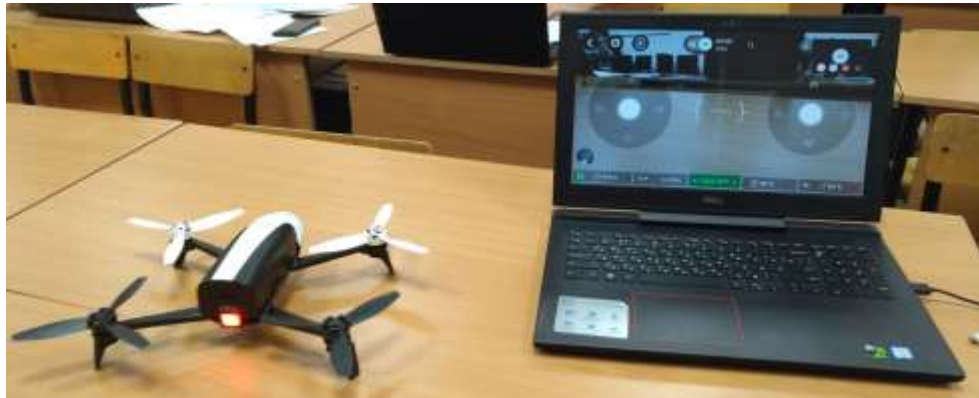
Рисунок 5.5 – Трансляция видеоизображения с квадрокоптера на экран ПК
