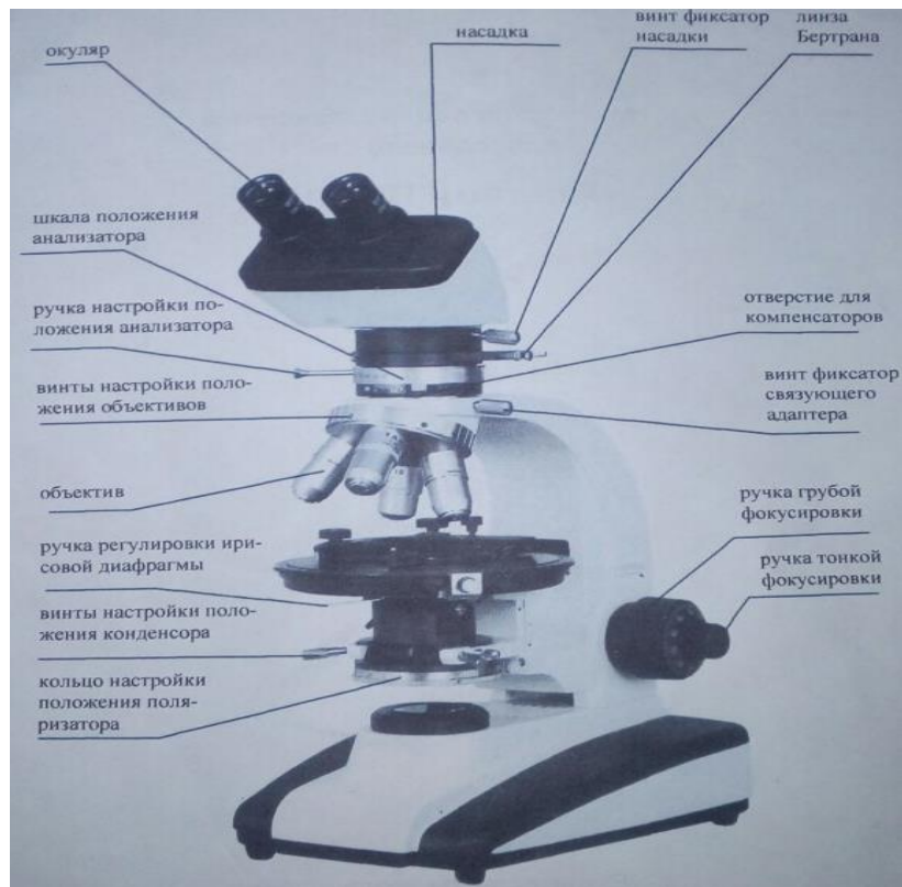
Рисунок 2 – Устройство поляризационного микроскопа «Альтами ПОЛАР 2»
