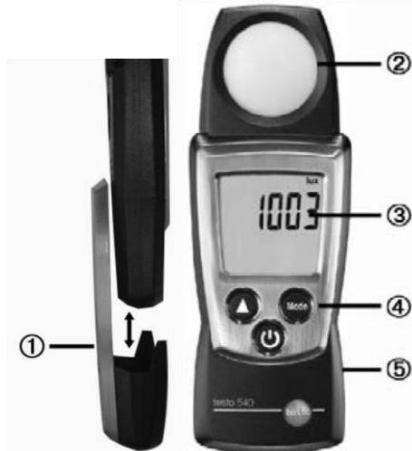
1 – защитный колпачок; 2 – сенсор освещённости; 3 – дисплей; 4 – функциональные кнопки;
