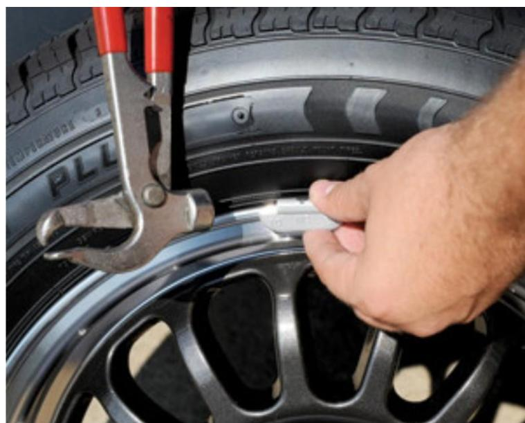
Рисунок 7.20 – Схема установки грузиков
