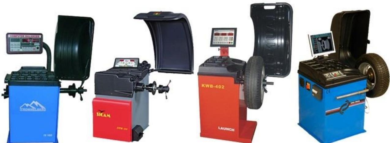
Рисунок 7.18 – Стенды для статической и динамической балансировки колес
