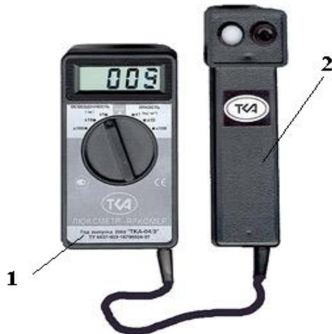
1 – Блок обработки сигналов; 2 – Фотометрическая головка
