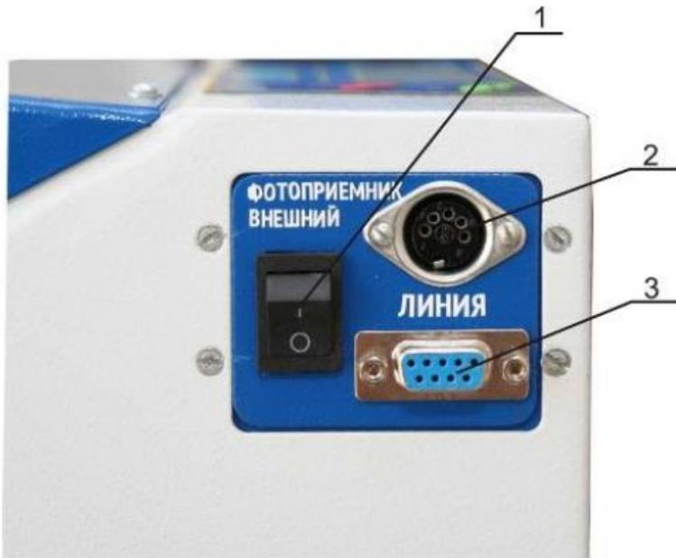
1 – выключатель фотоприемника внешнего; 2 – разъём подключения выносного датчика указателей поворота; 3 – разъём для подключения линии диагностического контроля.
