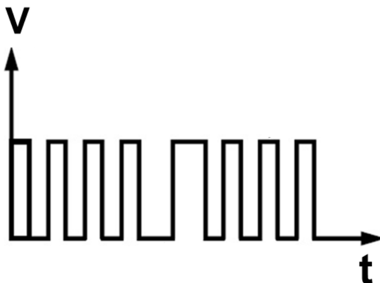
Рисунок 4.10 – Форма выходного сигнала датчика положения коленчатого вала на основе эффекта Холла
