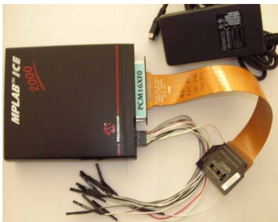
Рисунок 5.3 – Внутрисхемный эмулятор MPLAB ICE 2000
