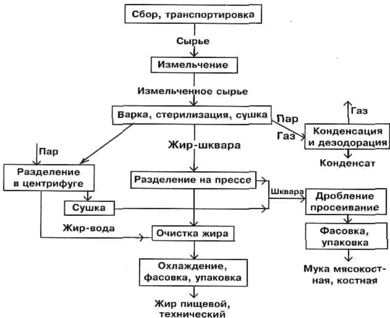
Рисунок 9.1- Схема технологии переработки жиросодержащего сырья (мягкого и твердого) сухим способом
