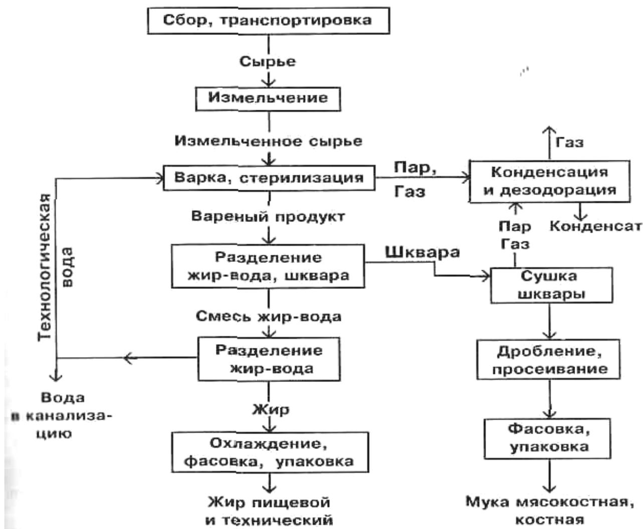
Рисунок 9.2 - Схема технологии переработки жиросодержащего сырья (мягкого и твердого) мокрым способом
