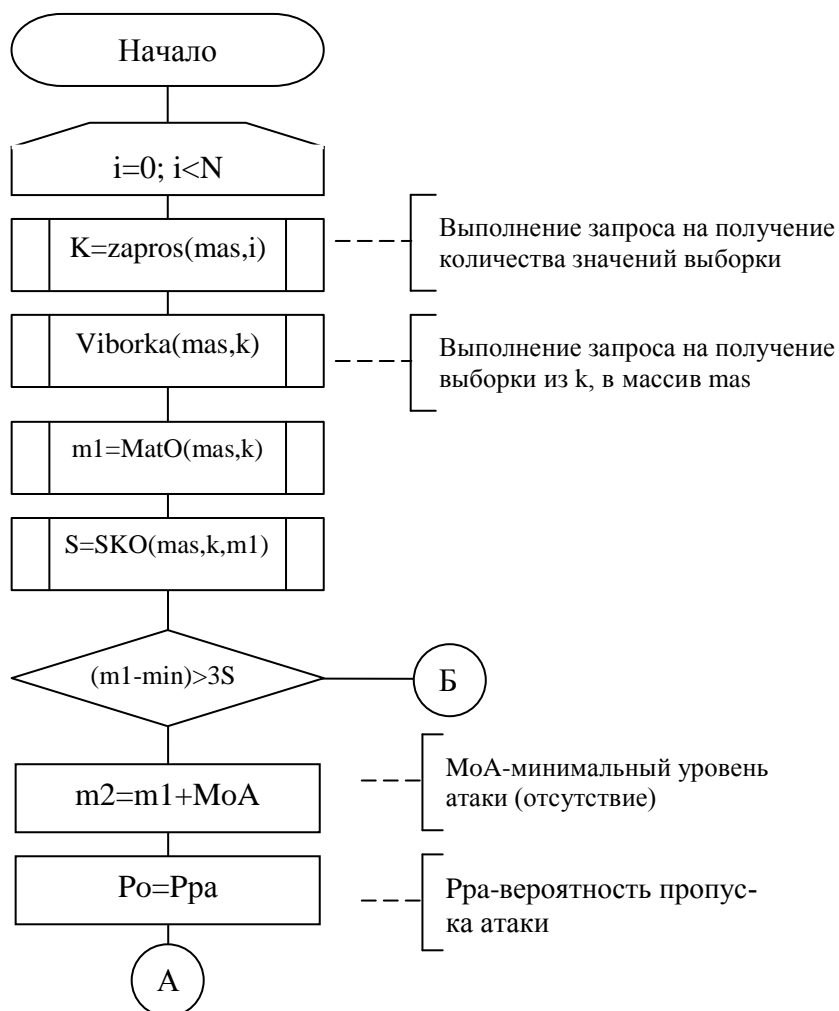
Рисунок 10.4 – Схема алгоритма расчета порогового значения SrF (лист1)
