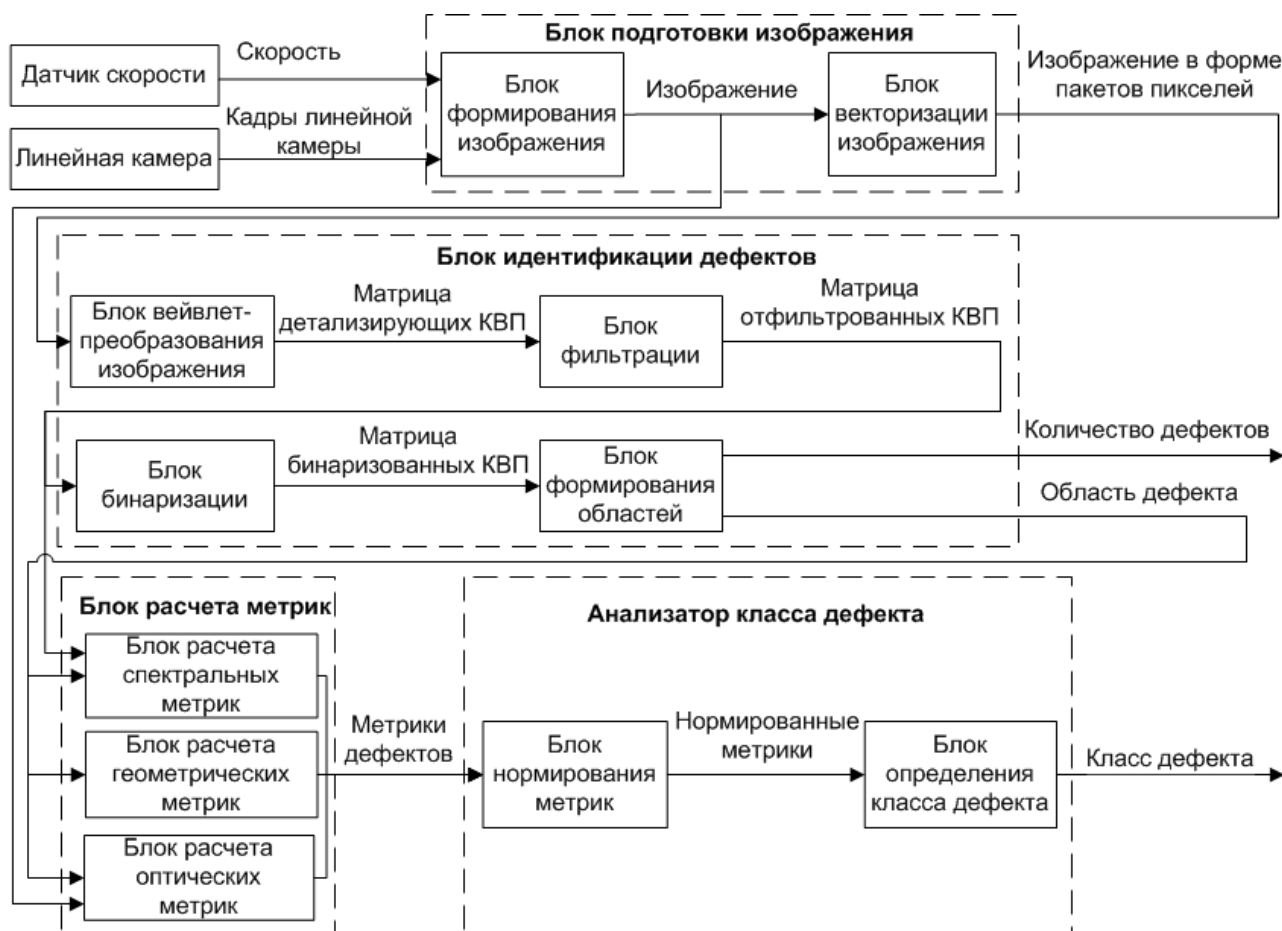
Рисунок 3.1 – Реализация концепции СКЗ идентификации и распознавания поверхностных дефектов тонколистового проката
