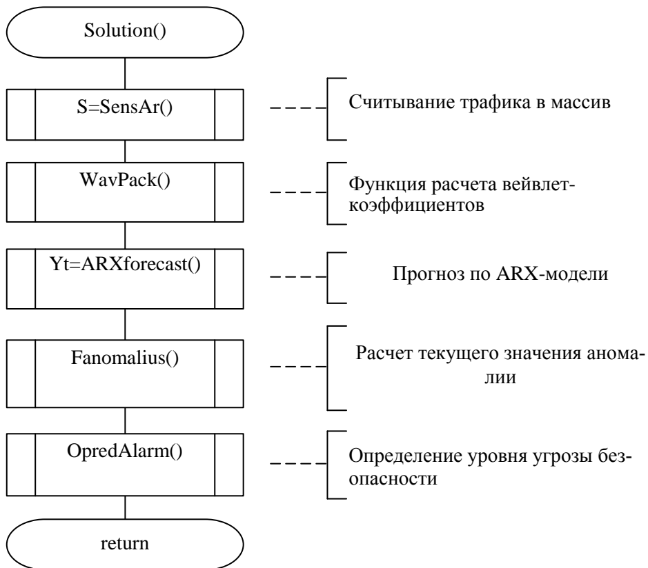
Рисунок 9.5 – Алгоритм определения уровня угрозы безопасности Solution()
