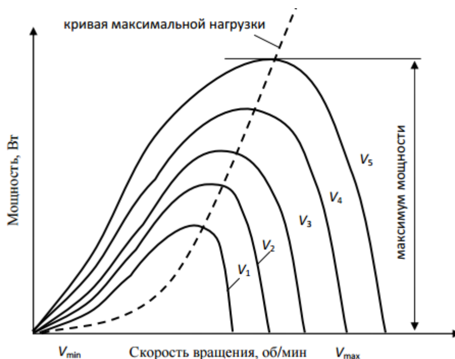
Рисунок 21 - Типичные зависимости выходной мощности ВЭУ от величины нагрузки
