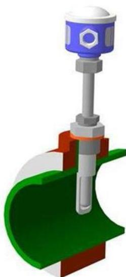
Рисунок 26– Монтаж термометра сопротивления на трубопроводе
