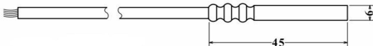
Рисунок 17 – Внешний вид вставляемого ПТ (масса не более 0,4 кг).
