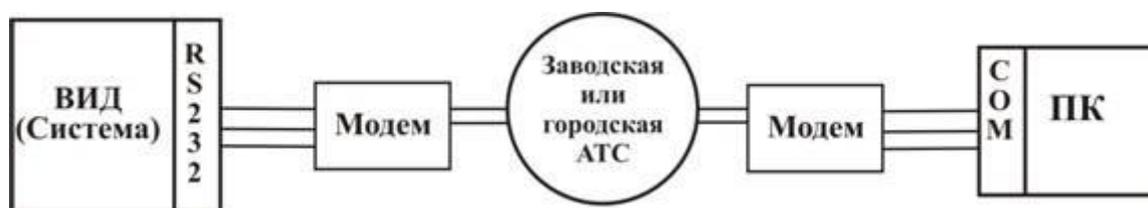
Рисунок 7 – Интерфейсы при модемной линии связи
