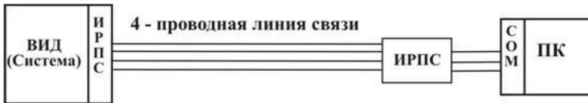
Рисунок 8 – Интерфейсы при 4-проводной линии связи
