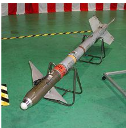
Dessin 1 – Le missile air-air AIM-9 Sidewinder, à guidage infrarouge.
